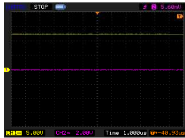
整流回路の出力波形 5v/div 約1.2Vの直流電圧
